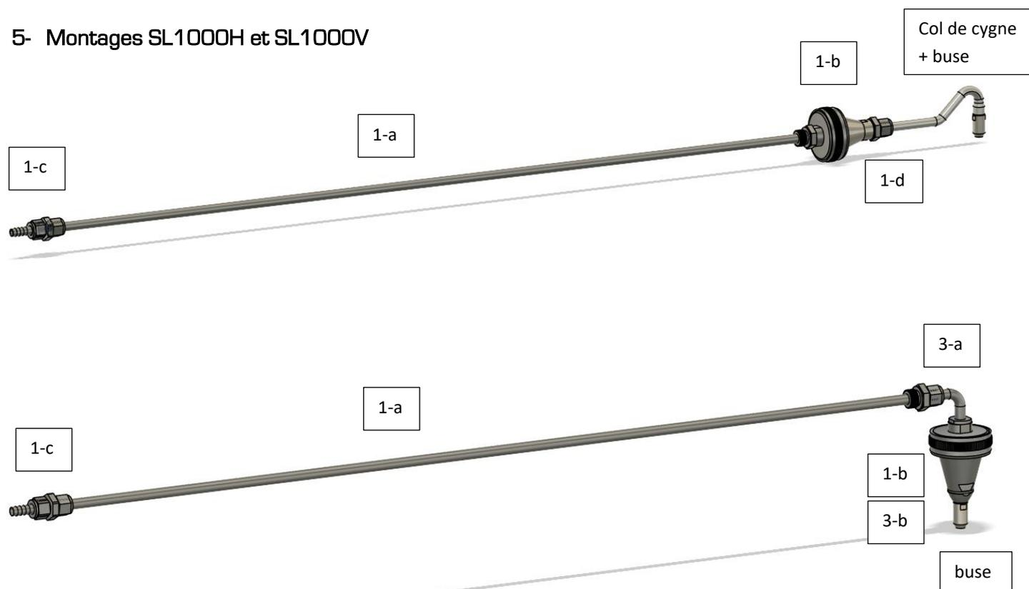
**NB : possibilité de monter des rallonges de 0.5 à 1m avec le DCFU14 en interconnexion. Dans ce cas ne pas oublier les bagues AV/AR à serrer sur les rallonges, et enlever la cannelure.**
