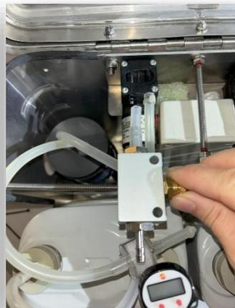
3- Reconnecter le tube d'entrée de la pompe sur l'entrée de la vanne
